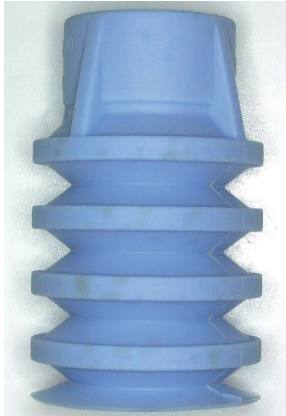
図、黒いシミが発生したパッド
